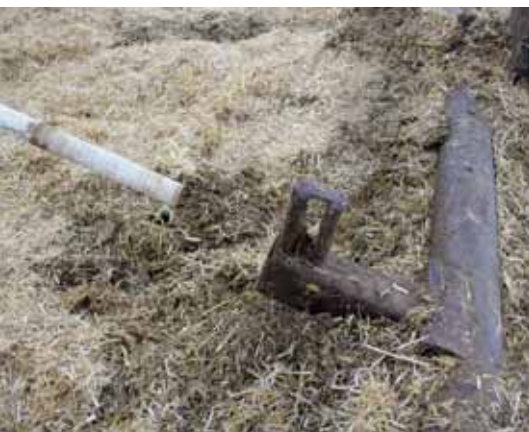
Die 1,80 m langen Fiberglasstangen werden einfach in ein Stahlrohr gesteckt.
